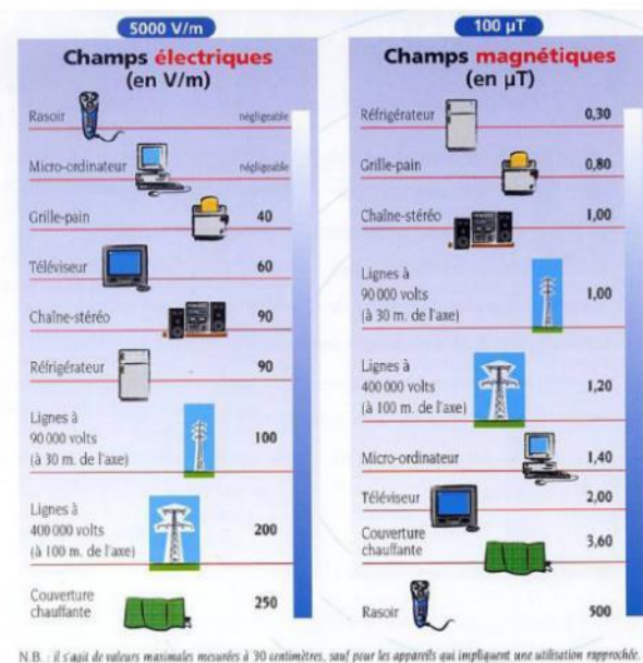
Figure 2_Comparaison entre champs électriques et champs magnétiques (source : RTE)
